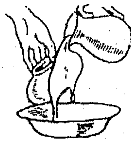
شكل (١٠) رسم يوضح طريقة السكب وهي لا تصلح لحريق الواحد
